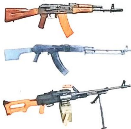
Рис. 51. 5,45 мм автомат Калашникова АК-74, 5,45 мм ручной пулемёт Калашникова РПК-74 7,62 мм пулемёт Калашникова ПК
