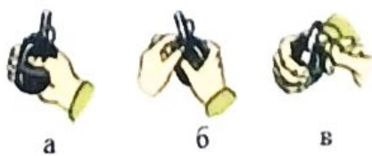
Рис. 37. Действия перед метанием ручной осколочной гранаты а - прижатие спусковой скобы к корпусу гранаты, б - выпрямление концов предохранительной чеки, в - выдергивание предохранительной чеки
