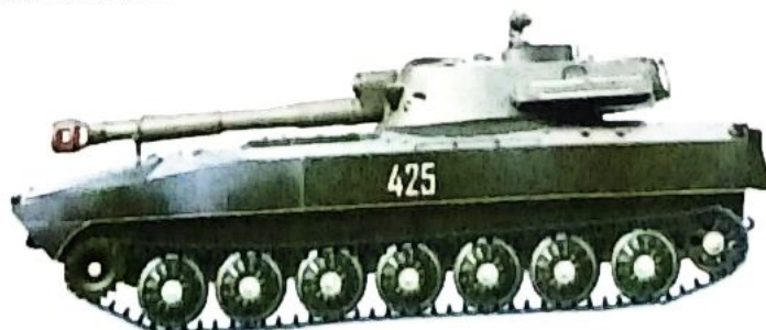
Рис. 47. 122-миллиметровая самоходная гаубица «Гвоздика»
